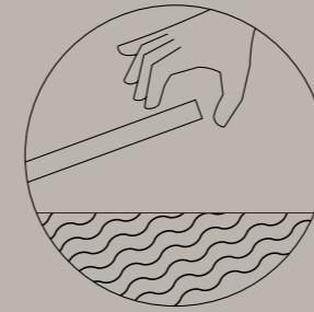
Posa su massetto con colla/ Laying on screed with adhesive
